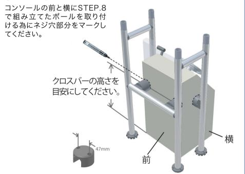
コンソールの固定用にマークしたネジ部をドリ ル等で穴を空け、付属のボルト・ナットで固定し てください。
