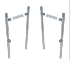
STEP.6で組み立てたH型ポールにクロ スバーを差し込み繋ぎあわせて固定して ください。
