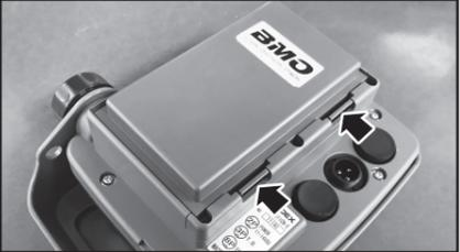
2カ所のロックを押して、ロックを外します。
