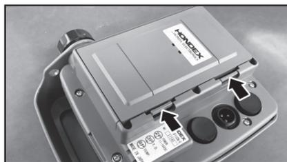
2カ所のロックを押して、ロックを外します。
